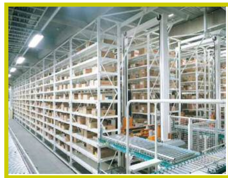
カートン(ケース)自動倉庫
