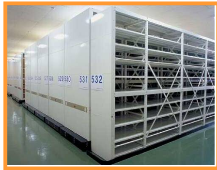
高層式電動移動ラック
