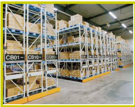
電動式移動パレットラック
