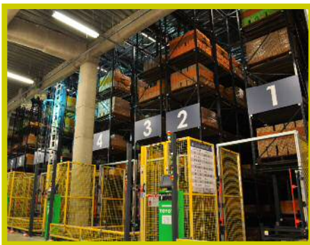
パレット自動倉庫
